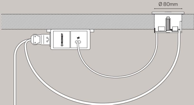
Divus con carga inteligente incorpora un cable de USB tipo C y otro con conector rápido en el extremo, proporcionando una conexión rápida y sencilla al módulo de carga (Docking).
