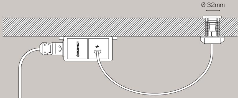
Bit incorpora un cable de conexión USB (tipo A o tipo C), proporcionando una conexión rápida y sencilla al transformador de carga (Docking).
