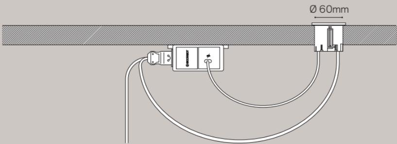
Atom con carga inteligente incorpora un cable de USB tipo C y otro con conector rápido en el extremo, proporcionando una conexión rápida y sencilla al transformador de carga (Docking).
