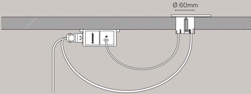
Orbit con carga inteligente incorpora un cable de USB tipo C y otro con conector rápido en el extremo, proporcionando una conexión rápida y sencilla al transformador de carga (Docking).
